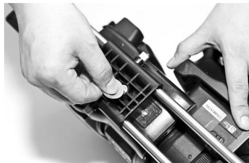
3. L자형 슬라이드(ML-SL30)를 카메라/삼각대 결합용 받침대(ML-AT1)의 슬라이드 홈에 끼워 결합시킨 후 슬라이드 고정용 나사로 움직이지 않게
