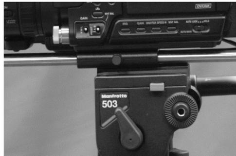
△ 주의: 슬라이드의 길이를 늘린 상태에서 무리한 힘 또는 충격을 가하면 슬라이드 및 카메라 하단의 연결부위가 파손될 수 있습니다. 카메라에 배터리 연결용 슬라이드와 카메라/삼각대 결합용 받침대(ML-AT1)를 장착한 상태에서 이동 할 때는 슬라이드의 길이를 최대한 짧게 조절해 주시기 바랍니다.
