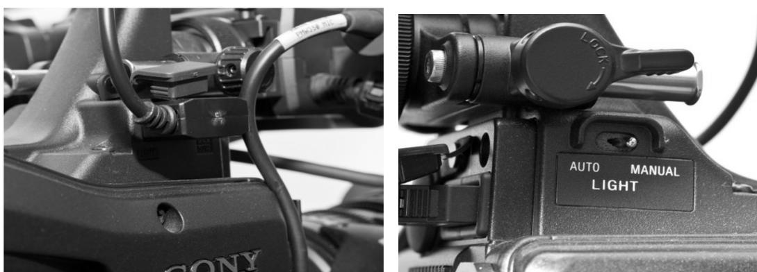
4. ENG카메라의 Cue/Cut 조작 버튼과 ML-115R LED Light가 서로 연동되어 작동 하도록 하려면, ML-115R LED Light의 전원 On/Off 스위치를 눌러 라이트를 점등 시킨 후 ENG Camera의 Light Power 선택 모드를 Auto위치로 가도록 하고 ML-115R LED Light의 전원 On/Off 스위치를 3초간 눌러 ML-115R LED Light가 Auto 모드로 전환되도록 합니다. ML-115R LED Light의 Auto 모드를 다시 Manual 모드로 전환 하려면 ML-115R LED Light의 전원이 켜진 상태에서 On/Off 스위치를 3초간 다시 누르면 됩니다.
