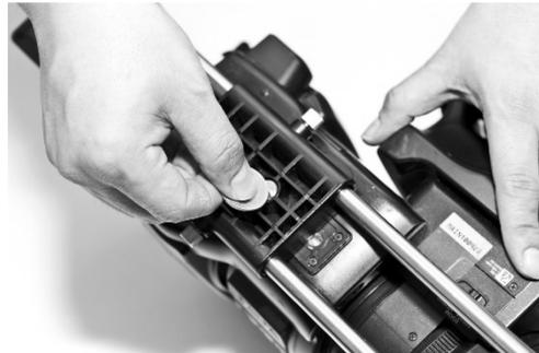
3. L자형 슬라이드(ML-SL30)를 카메라/삼각대 결합용 받침대(ML-AT1)의 슬라이드 홈에 끼워 결합시킨 후 슬라이드 고정용 나사로 움직이지 않게 조여 줍니다. 배터리(ML-BA12)의 L자형 슬라이드 결합홈에 L자형 슬라이드(ML-SL30)를 끼워 결합시킨 후 배터리의 12V DC IN/Out 단자와 LED 라이트(ML-9)의 12V DC IN 단자를 별도의 전원 케이블(ML-PC1)로 연결 합니다.
