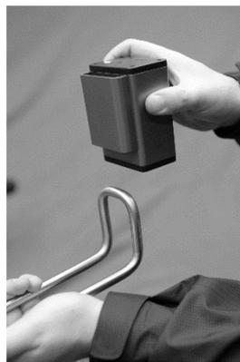
c. 다 사용한 배터리를 빼내고, 충전된 새 배터리를 L자형 슬라이드 연결부 위에 결합 합니다.
