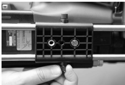
3 L型スライドをML-AT1に装着し、バッテリーを固定後、ML-PC1ケーブルでML-Xライトの12V入力に接続します。
